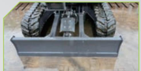
Das Hydrauliksystem der Planierraupe ist mit einer Schutzeplatte ausgestattet, um schwierigen Arbeitsbedingungen gerecht zu werden und gleichzeitig den Zylinder und die Leitungen zu schützen.
