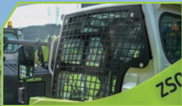
Optionaler Kabinenseitenschutz Der Seitenschutz gewährleistet Ihre seitliche Sicherheit.
