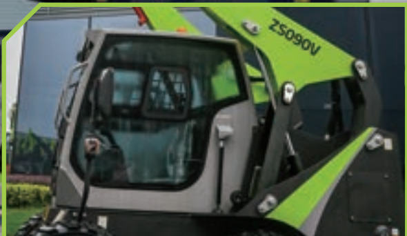
Die Hydraulikleitungen befinden sich im Inneren des Hebearms, sodass sie perfekt geschützt sind.
