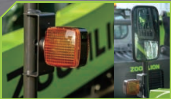
Optionale Blinker und Außenspiegel Sie bewegen sich nicht mit dem Hubarm, sodass Sie die Situation hinter der Maschine jederzeit gut beobachten können und sicher bleiben.
