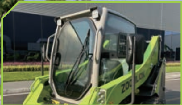
FOPS/ROPS-Kabine Eine FOPS/ROPS-zertifizierte Kabine bietet Schutz bei unvorhergesehenen Überschlügen und herabfallenden Gegenständen.
